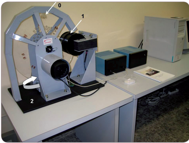
Figure 3.2: Les courbes d'hystérésis sont obtenues dans le magnétomètre rotatif. L'échantillon est monté à l'intérieur du disque en plexiglas (flèche 0). Lors de la rotation du disque, l'intensité du champ magnétique est incrémentée chaque fois quand l'échantillon passe dans l'entrefer de l'électroaimant (flèche 1) où l'aimantation induite est mesurée. L'aimantation rémanente est mesurée dans une autre bobine de détection (flèche 2) qui se trouve en champ nul.
