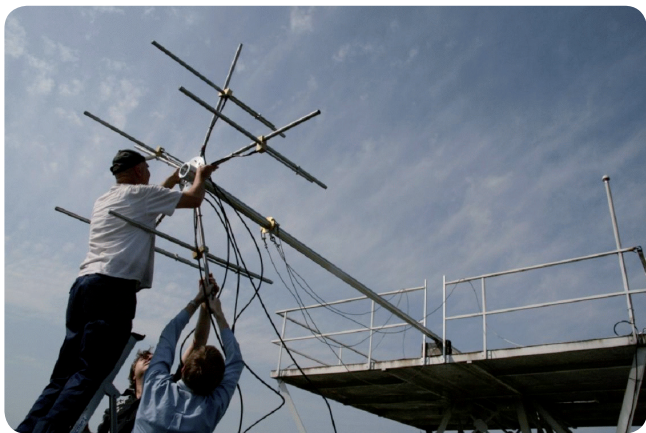
Figure 4.3: antenne interférométrique installée à Uccle
