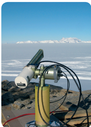
Figure 4.5 : (à gauche) Le photomètre solaire CIMEL, installé sur la base princesse Élisabeth, mesure l'atténuation totale de la lumière solaire due aux aérosols. (ci-dessus) Épaisseur optique de l'aérosol (mesure de l'atténuation de la lumière solaire) et colonne d'eau intégrée (quantité d'eau atmosphérique susceptible de produire des précipitations) le 16 février 2009, mesurées par le photomètre solaire.
